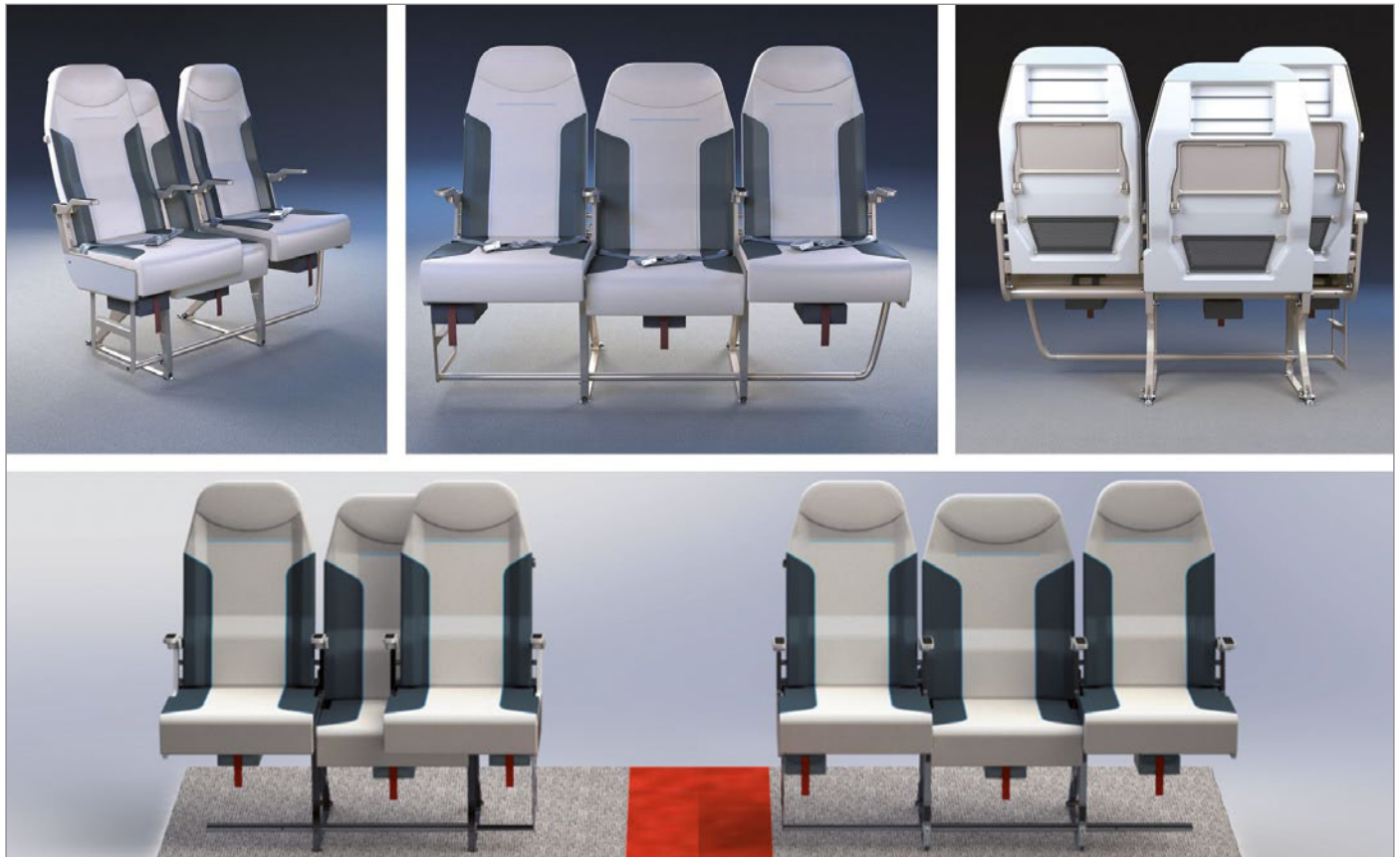
Innovatives Sitzkonzept – Side-Slip Seat: Ist die Sitzreihe unbesetzt, steht während des Einsteigens ein breiterer Gang zur Verfügung
